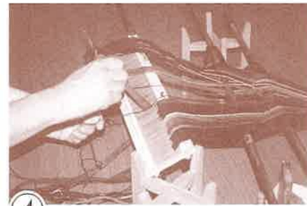
④ くし目 くしめ 状 じょう に竹 たけ をうすくならべた おさ 箆 へら に幅 あ を決めた き タテ糸 たていと の上糸 うわいと と下糸 したいと を順番 じゅんばん にとおしていく。
