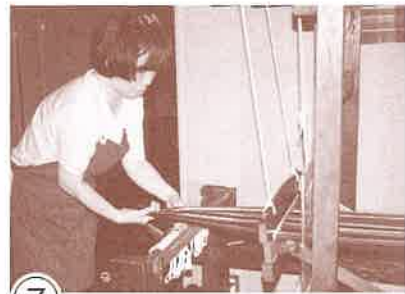
⑦ タテ糸 たていと をチマキ ちまき に巻 ま きながら、タテ糸 たていと の ちまき はりを調節 ていせつ する。
