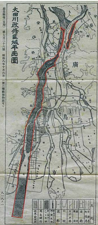
昭和8年(1933)時点の太田川改修予定図。赤いラインが完成予定の放水路(川幅が広い)。当館蔵
